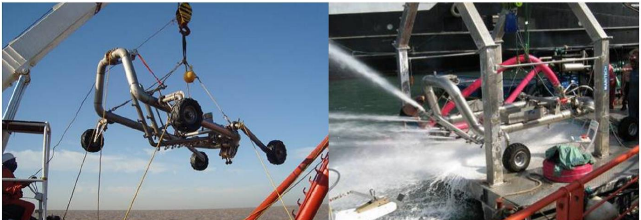
Figure 28 : Trencher de type « jet sledge » permettant l'ensouillage des câbles) (Orange Marine)
