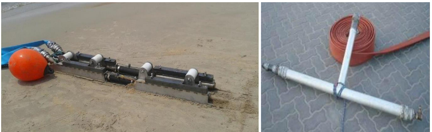
Figure 29 : « Jet sledge » de type WORM pour les eaux très peu profondes (à gauche), lance à eau d'ensouillage (à droite)
