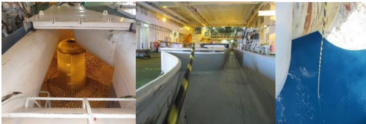
Figure 34 : Déploiement d'un câble depuis la cuve de stockage (photos : setec in vivo)
