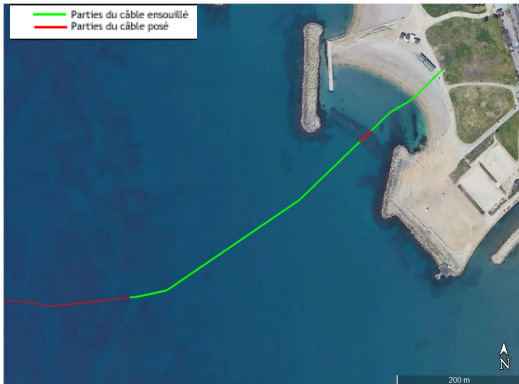
Figure 26 : Zones d'ensouillage du câble
